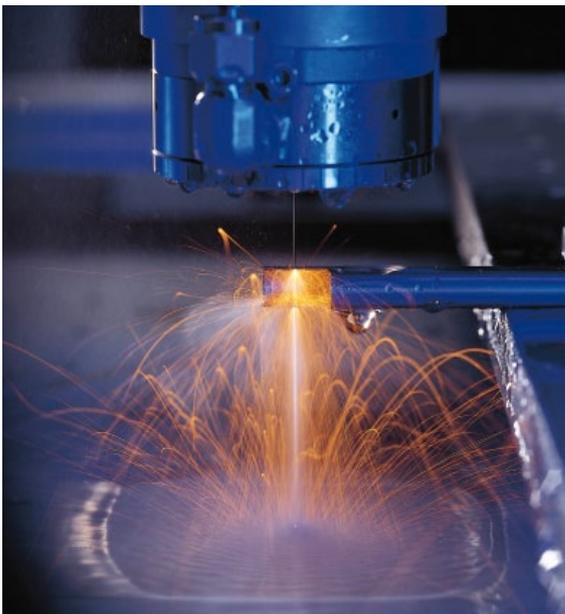
Abb. 1 Das Laser MicroJet-Schneiden eignet sich für viele industrielle Anwendungen.
